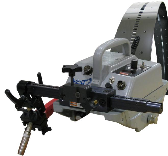
O sistema Gullco Flex KAT® é utilizado mundialmente para a automatização de uma grande variedade de aplicações em soldagem e corte. É um sistema robusto, com carrinho de deslocamento preciso para uso com trilho flexível, que o habilita a operar em superfícies retas ou curvas ao longo de qualquer plano. A Gullco fabrica vários sistemas e acessórios projetados para uso com o sistema Flex KAT®, tornando-o uma das mais versáteis ferramenta para automatização de soldagem e corte
