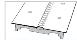
Reforço para Trilho Flexível. Seções de Alumínio extrudado, para montagem com o trilho flexível Gullco "Flex-Track" destinado a aplicações com trilhos rígidos. Fornecidos com 2438 m.
